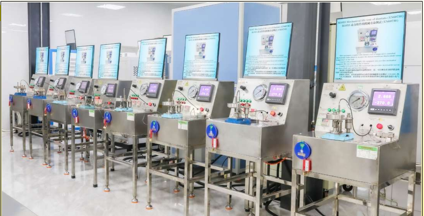
Reihe von mechanischen Lebensdauerestgeräten für Diastate Jedes Gerät ist mit einem Datenrekorder ausgestattet, der die Testparameter und die Anzahl der Zyklen aufzeichnet. (Ultimheat Labor)
